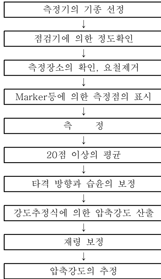
【그림 1.2.2】 반발경도법에 의한 압축강도 추정도
